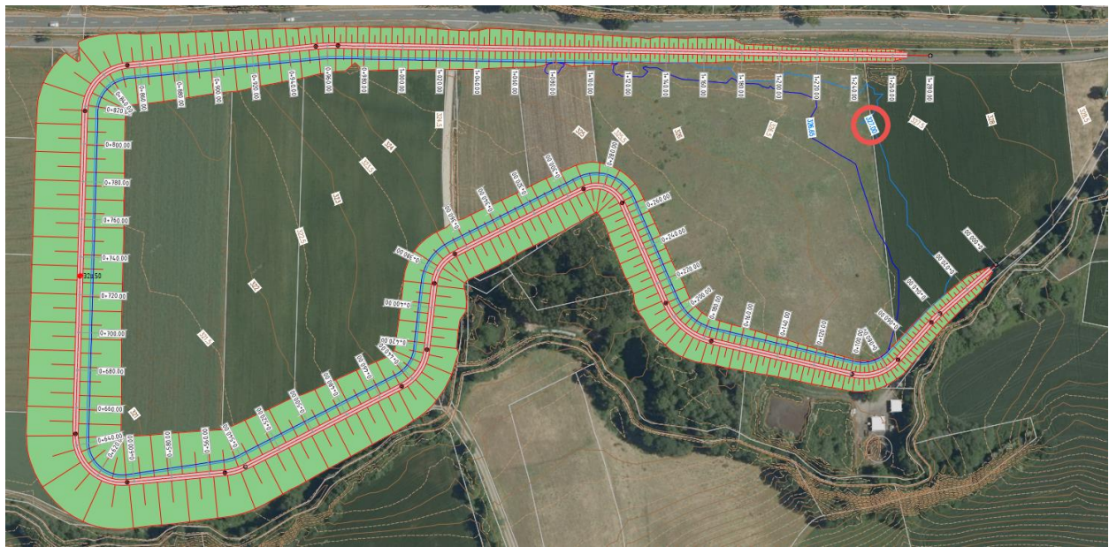
Abbildung 45: Dammvariante und Einstaubereich am Becken 4 – Variante 9 (Anlage 1.05)
