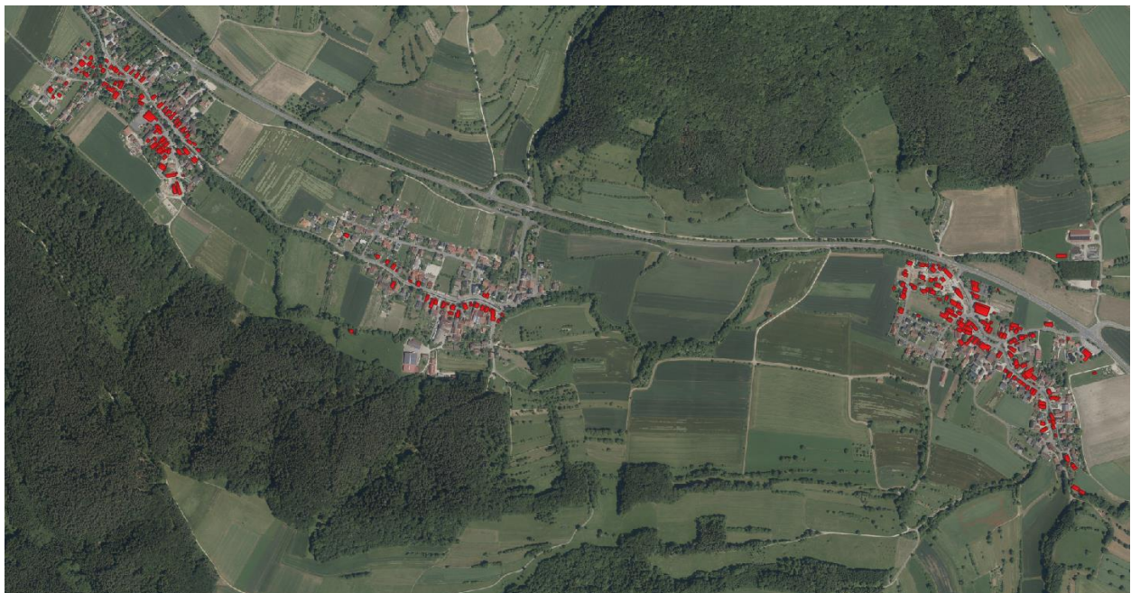
Abbildung 9: Variante 1 - betroffene Gebäude (rot)
