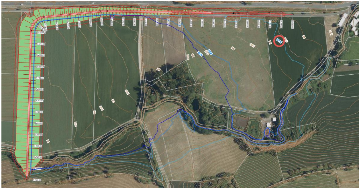
Abbildung 49: Dammvariante und Einstaubereich am Becken 4 – Variante 10 (Anlage 1.04)
