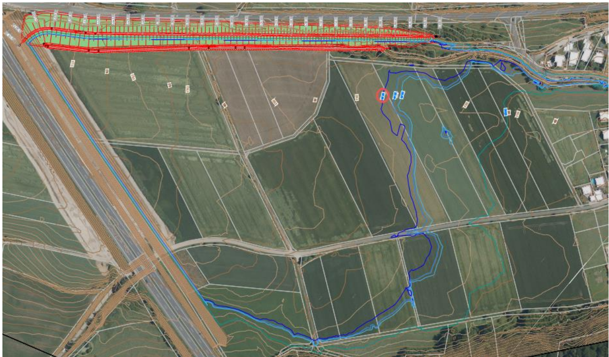
Abbildung 16: Dammvariante und Einstaubereich am Becken 1 – Variante 3 (Anlage 1.01)
