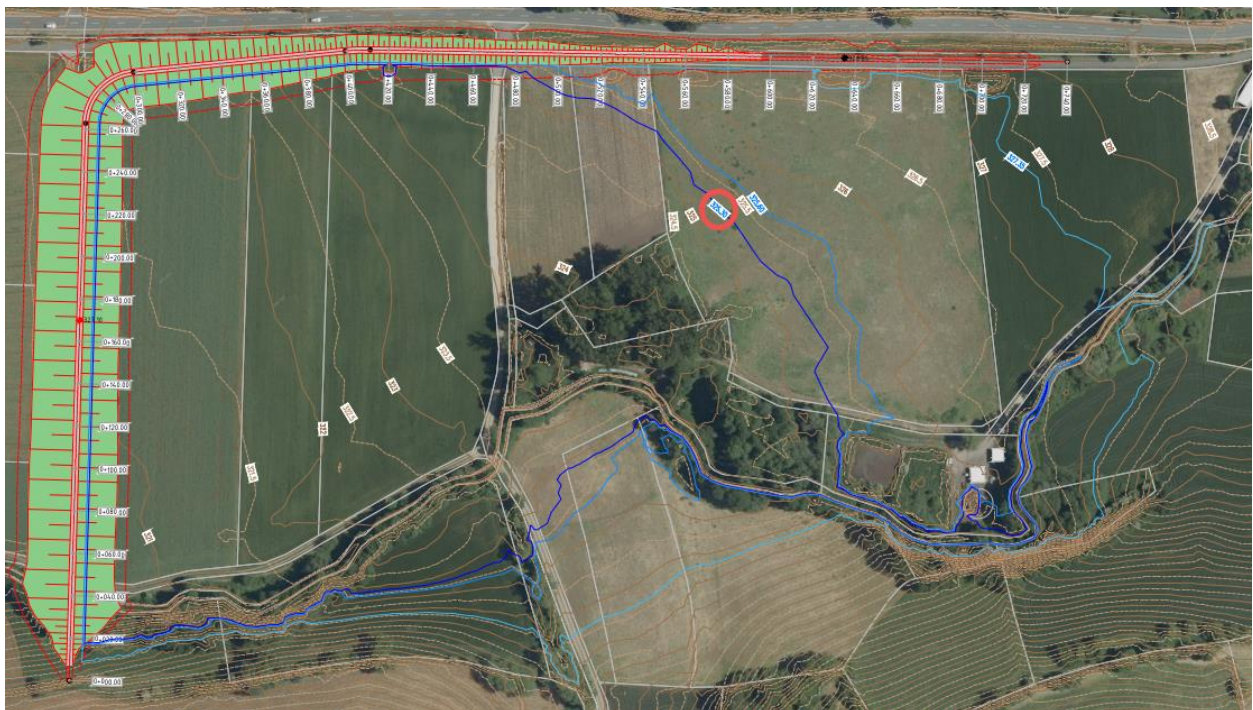
Abbildung 22: Dammvariante und Eintaubereich am Becken 4 – Variante 4 (Anlage 1.04)
