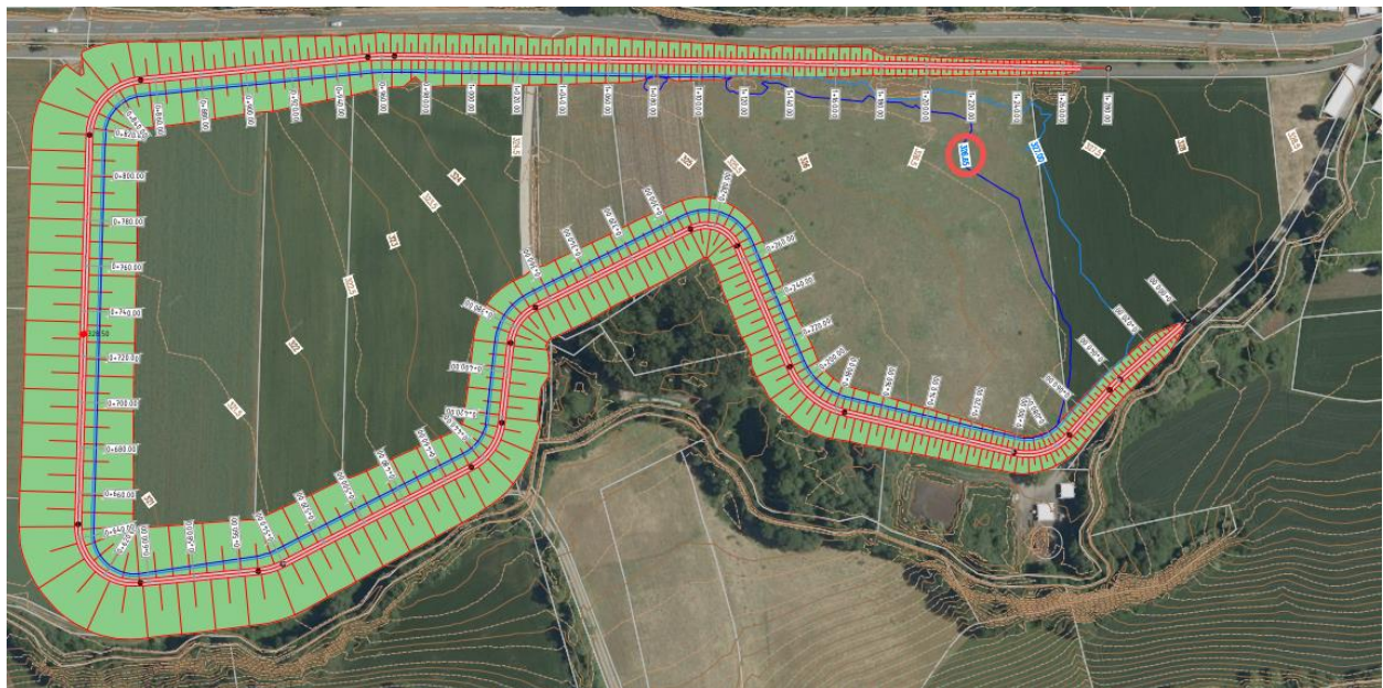
Abbildung 27: Dammvariante und Einstaubereich am Becken 4 – Variante 5 (Anlage 1.05)
