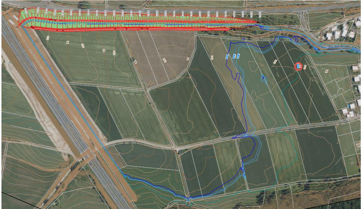
Abbildung 4: Dammvariante und Einstaubereich am Becken 1 – Variante 1 (Anlage 1.01)
