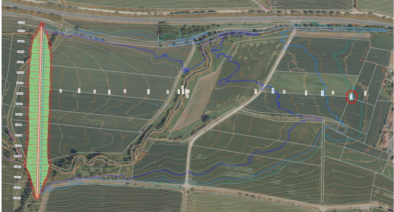
Abbildung 44: Dammvariante und Einstaubereich am Becken 2 – Variante 9 (Anlage 1.02)
