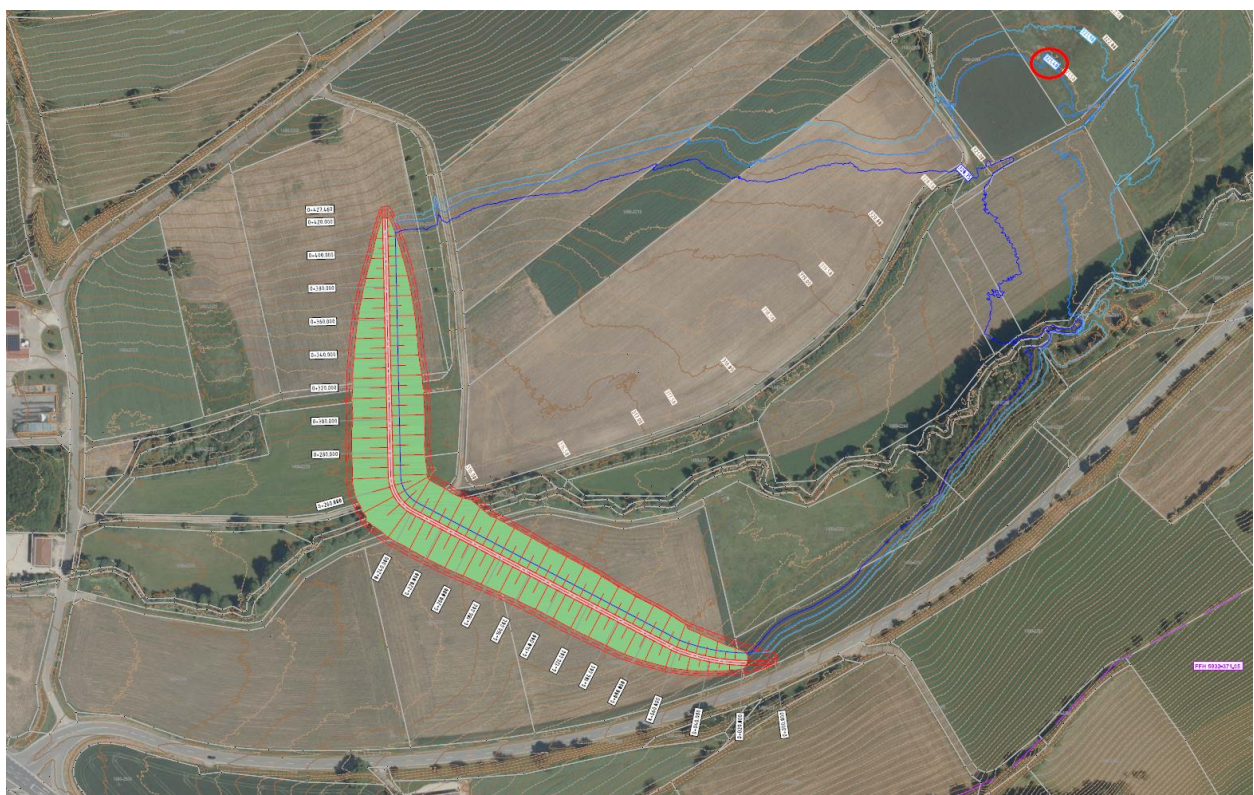
Abbildung 35: Dammvariante und Einstaubereich am Becken 3 – Variante 7 (Anlage 1.03)
