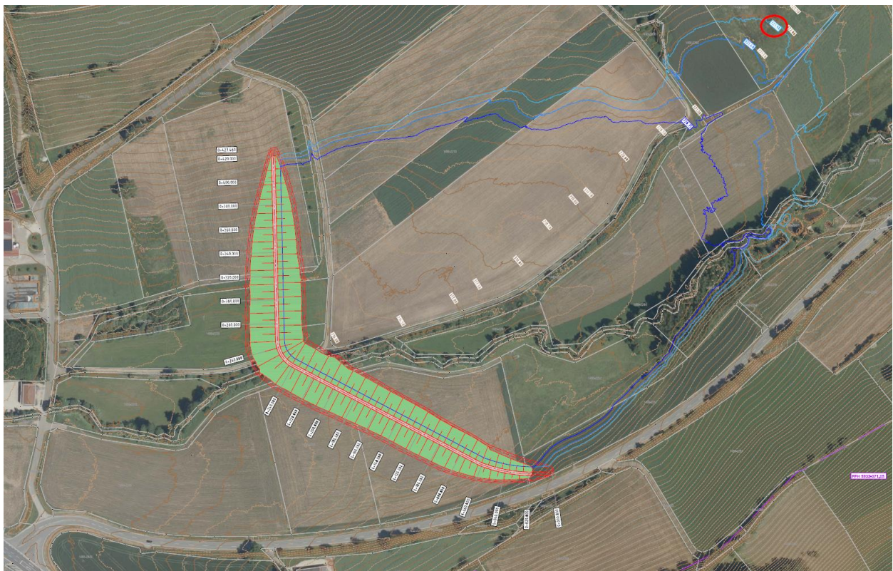
Abbildung 48: Dammvariante und Einstaubereich am Becken 3 – Variante 10 (Anlage 1.03)
