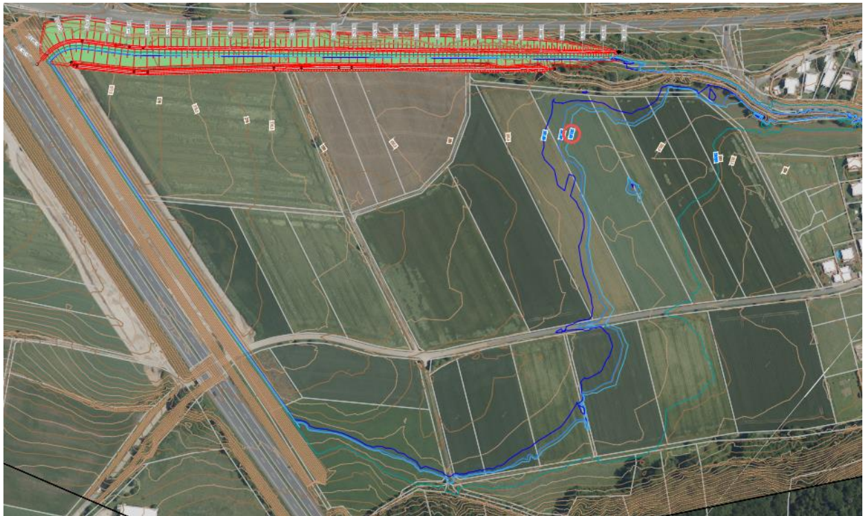
Abbildung 21: Dammvariante und Eintaubereich am Becken 1 – Variante 4 (Anlage 1.01)
