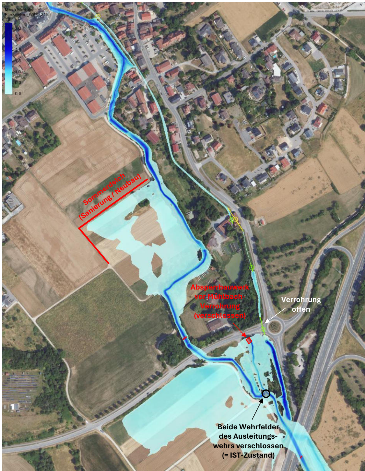
Abbildung 64: Zukünftiges Ü-Gebiet im Bereich der Hopfenmühle
