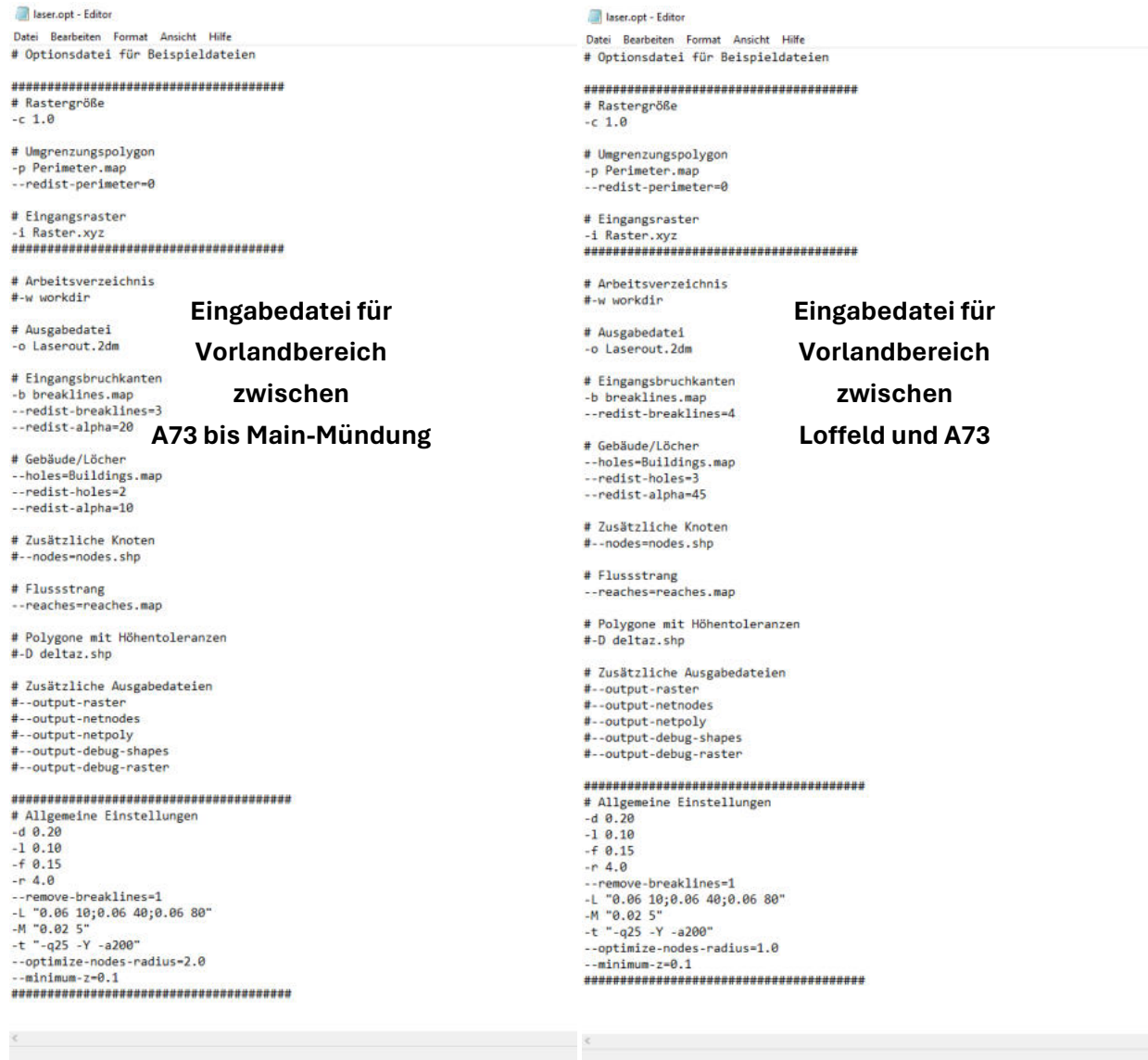
Abbildung 43: Eingabedatei LASER_AS für Vorlandmodellerstellung
