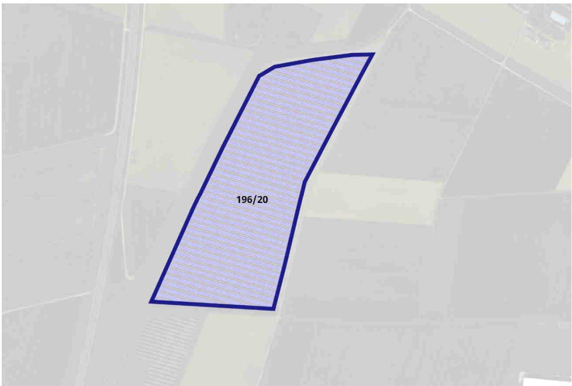
Die Modulreihennormalen sollen mit einer Ausrichtung auf 196° Südsüdwest mit einer Aufneigung auf 20° montiert werden.
